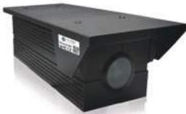
SmarteCAM 스마트 카메라는 AI 툴킷이 포함되어 있다. SmarteCAM은 높은 동적 범위 및 초 저조도 성능 이미지를 지원하는 이미지 신호 프로세서가 있는 Sony Starvis IMX290 이미지 센서를 기반으로 한다. 이 카메라에는 인공지능에 기반을 둔 애플리케이션을 지원하기 위해 256코어 GPU가 탑재된 NVIDIA TX2 모듈도 있다. 소프트웨어 패키지에는 CUDA, OpenCV, Python 포함되어 있다. 온보드 32GB eMMC 5.1 스토리지는 microSD 카드 지원으로 확장 가능하다.
