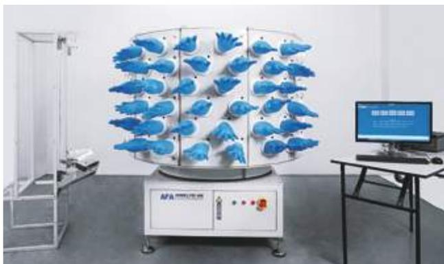
에이에프에이 테크놀로지, LTM 120 테스트 시스템. 120개의 테스트 맨드릴이 천연 고무와 니트릴로 만든 일회용 장갑을 테스트한다. (출처: AFA)
