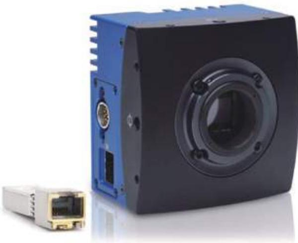
EoSens Creation Series 카메라는 이미지 보정 애플리케이션에 적합하다. 이 카메라 라인은 Xilinx Kintex Ultrascale FPGA 및 2GB DDRD 메모리를 특징으로 하며 엣지 컴퓨팅 애플리케이션용으로 설계되었다. 이 카메라에는 536fps에서 10비트 이미지를 외부적으로 스트리밍하거나 2240fps에서 내부적으로 8비트 이미지를 스트리밍 할 수 있다. 550nm 파장에서 20V/Lux 감도를 제공할 수 있는 2MPixel 10GigE GenICam 호환 카메라가 장착되어 있다.
