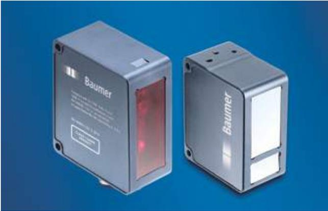
Baumer의 스마트 멀티 툴 프로파일 센서 OXM은 통합된 측정 기능과 간단한 사용성으로 인해 개별 측정 작업에 빠른 솔루션을 제공한다. 보다 정밀한 작업을 위해, 이제 OXM200에 청색 레이저 빔도 사용할 수 있다. 청색 레이저 광의 단파장은 공간 노이즈를 줄여 최대 3 μm의 분해능과 25 mm의 측정 범위로 플라스틱과 같은 까다로운 재료에 대해서도 정확한 측정 결과를 제공한다.
