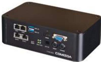
최근 개발된 Compact IPC 기반 EtherCAT 마스터는 국내 자동화 산업에서의 새로운 혁신을 불러온 제품으로 커미조아의 끊임없는 도전과 열정으로 한 발 앞선 업계 최고 수준의 네트워크 실현 제품이라고 할 수 있다. 이 제품은 커미조아의 독립형 EtherCAT Master Controller로 x5-E3940(Inter사) CPU를 사용한 Supermicro SBC보드를 내장했으며 Windows 10 IoT 운영체제를 사용한다. 또한 PCI Express 기반 EtherCAT Master 보드로써 16축, 32축 제어 가능하다.
