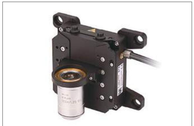
그림 6. V-308 보이스코일 스캐너. 8m/s<sup>2</sup>의 가속도, 이동 범위 7mm (사용자가 조정할 수 있는 하드 스톱으로 조정 가능)
