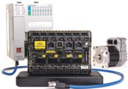
Teknic은 최근 Ethernet/IP 호환 PLC 사용자를 위한 모션 및 I/O 컨트롤러인 ClearLink를 출시했다. ClearLink는 Teknic의 ClearPath 통합 서보, 타사 스테퍼 드라이브 또는 디지털 서보 드라이브가 있는 브러시리스 서보 모터에 대해 최대 4축 모션제어를 제공한다. ClearLink는 디지털 및 아날로그 입력 및 출력과 함께 13개의 산업용 24V I/O 포인트가 내장되어 있다. 출력은 별도의 릴레이 또는 클램핑 다이오드 없이 전원 차단 브레이크 또는 기타 유도성 부하를 직접 제어할 수 있으며, 또한 문제 해결 및 진단을 위해 모든 I/O 지점에 전용 LED가 있다. I/O 보안을 위한 8 포인트 I/O 확장 모듈(CCIO-8)로 최대 77개의 I/O 포인트까지 확장 가능하다. ㉔
